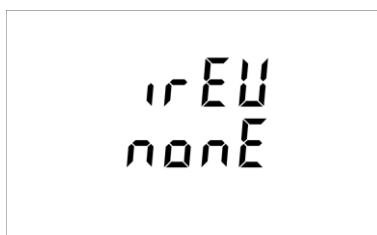
Na tym ekranie prądy we wszystkich 3 fazach nie mają odwróconego kierunku
