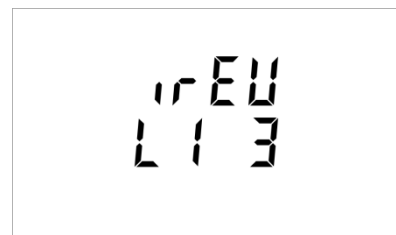
Na tym ekranie kierunek prądów w fazie L1 i L3 jest odwrótny.
