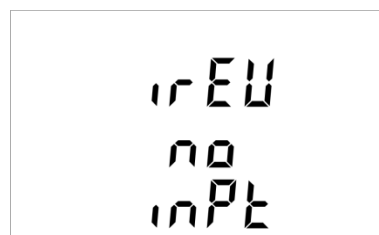
Na tym ekranie wejście prądowe nie jest podłączone do miernika.
